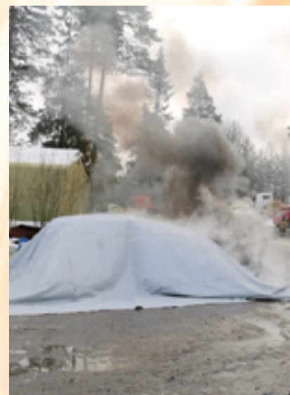
Alle foto: Bridgehill Innovation En bilbrann kveles effektivt ved hjelp av duken.
