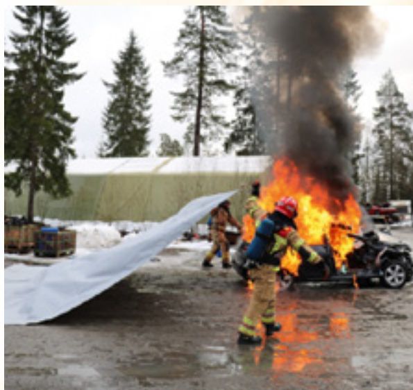
Alle foto: Bridgehill Innovation En bilbrann kveles effektivt ved hjelp av duken.
